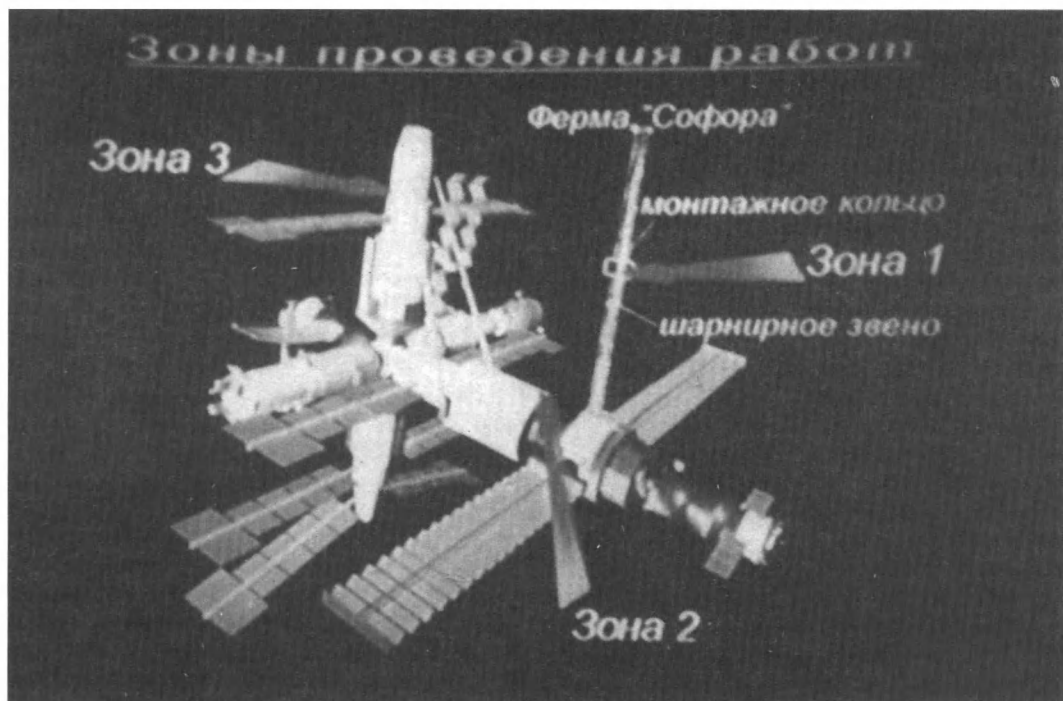
Схема проведения эксперимента "Рефлектор"
