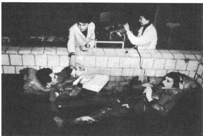
Воспроизведение действия невесомости на организм человека с помощью водной иммерсии (имитация потери веса). Испытатели одеты в гидрокостюмы и погружены в жидкость равного им удельного веса
