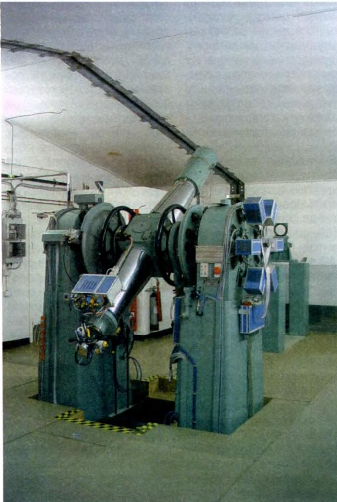
*Меридианный круг в обсерватории в г. Ла Пальма на Канарских островах. С инструментами такого типа до недавнего времени устанавливалась фундаментальная система координат, определяемая движением Земли.*
