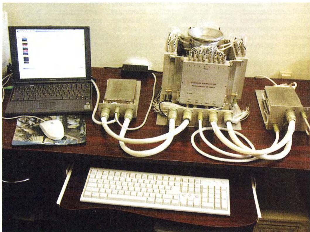
ной 4 м установлен магнитометр CM-8M, измеряющий три компоненты постоянного магнитного поля в диапазоне  $\pm 55$  мкТл.
