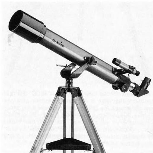
Телескоп "Synta Sky-Watcher 707AZ2" (Китай), апохромат: апертура  $D = 70$  мм; фокусное расстояние объектива  $F = 700$  мм; увеличение с окуляром 25 мм – 28-кратное, с окуляром 10 мм – 70-кратное; максимальное увеличение – 140 крат; разрешающая способность – не менее 2", проникающая сила – до 11.5"; масса телескопа – не более 5 кг; комплектуется альт-азимутальной монтажкой с тонкой коррекцией по вертикальной оси.
