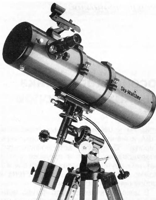
Телескоп "Synta Sky-Watcher 13065EQ2" (Китай), рефлексор Ньютона; апертура  $D = 130$  мм; фокусное расстояние объектива  $F = 650$  мм; увеличение с окуляром 25 мм – 26-кратное, с окуляром 10 мм – 65-кратное; максимальное увеличение – 260 крат; разрешающая способность – не менее 1", проникающая сила – до 13"; масса телескопа – не более 14 кг; комплектуется экваториальной монтировкой EQ2.
