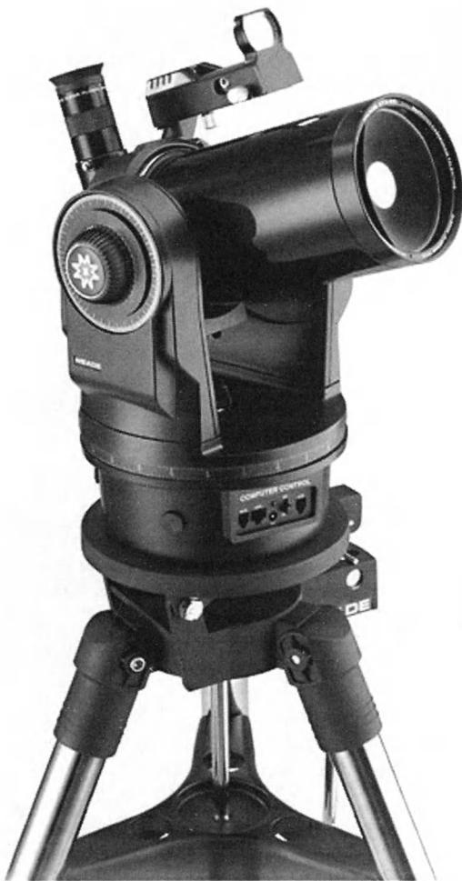
Телескоп "Meade ETX-90PE" (Мексика), менисковый Кассегрен с автоматическим наведением; апертура  $D = 90$  мм; фокусное расстояние объектива  $F = 1350$  мм; увеличение с окуляром 25 мм – 54-кратное; максимальное увеличение – 180 крат; разрешающая способность – не менее 1.6", проникающая сила – до 12<sup>m</sup>; масса телескопа – не более 10 кг; комплектуется полевым штативом.
