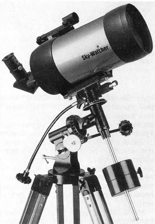
Телескоп "Synta Sky-Watcher MAK 102EQ2" (Китай), менисковый Кассегрен; апертура  $D = 102$  мм; фокусное расстояние объектива  $F = 1250$  мм; увеличение с окуляром 25 мм – 50-кратное, с окуляром 10 мм – 125-кратное; максимальное увеличение – 200 крат; разрешающая способность – не менее 1.2"; проникающая сила – до 12.5<sup>m</sup>; масса телескопа – не более 14 кг; комплектуется экваториальной монтировкой EQ2.
