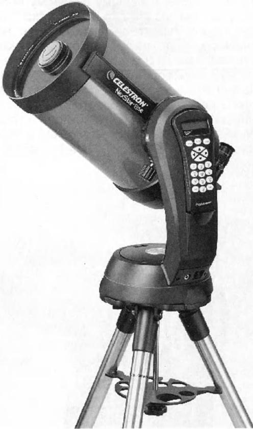
Телескоп "Celestron 8SE" (Китай), Шмидт-Кассегрен с автоматическим наведением; апертура  $D = 200$  мм; фокусное расстояние объектива  $F = 2000$  мм; увеличение с окуляром 25 мм – 80-кратное; максимальное увеличение – 400 крат; разрешающая способность – не менее 0.6"; проникающая сила – до 14<sup>m</sup>; масса телескопа – не более 15 кг; комплектуется полевым штативом.
