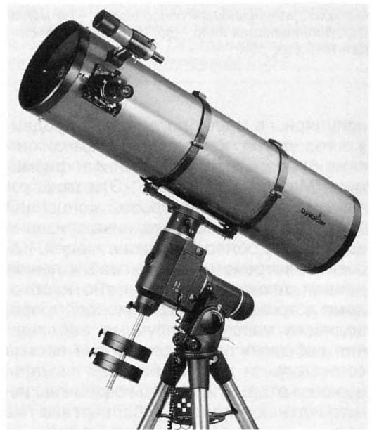
Телескоп "Synta Sky-Watcher 25012EQ6" (Китай), рефлектор Ньютона с автоматическим наведением; апертура  $D = 250$  мм; фокусное расстояние объектива  $F = 1200$  мм; увеличение с окуляром 25 мм – 48-кратное, с окуляром 10 мм – 120-кратное; максимальное увеличение – 400 крат; разрешающая способность – не менее 0.5"; проникающая сила – до 14.5<sup>m</sup>; масса телескопа – не более 40 кг; комплектуется экваториальной монтировкой EQ6.
