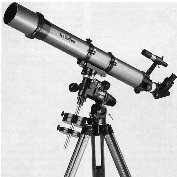
Телескоп "Synta Sky-Watcher 1021EQ3-2" (Китай), ахромат: апертура  $D = 100$  мм; фокусное расстояние объектива  $F = 1000$  мм; увеличение с окуляром 25 мм – 40-кратное, с окуляром 10 мм – 100-кратное; максимальное увеличение – 200 крат; разрешающая способность – не менее 1.4"; проникающая сила – до 12.5<sup>m</sup>; масса телескопа – не более 18 кг; комплектуется экваториальной монтировкой EQ3-2.
