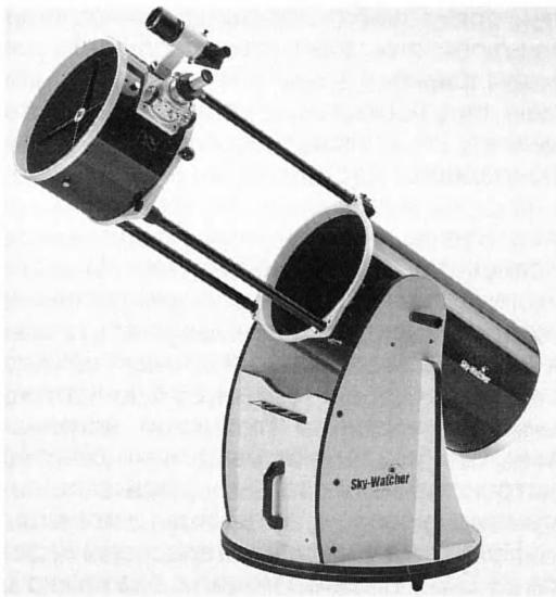
Телескоп "Synta Sky-Watcher Dob 12" (Китай), рефлексор Ньютона на монтировке Добсона с раздвижной трубой; апертура  $D = 300$  мм; фокусное расстояние объектива  $F = 1500$  мм; увеличение с окуляром 25 мм – 60-кратное, с окуляром 10 мм – 150-кратное; максимальное увеличение – 600 крат; разрешающая способность – не менее 0.3"; проникающая сила – до 15<sup>m</sup>; масса телескопа – не более 30 кг.
