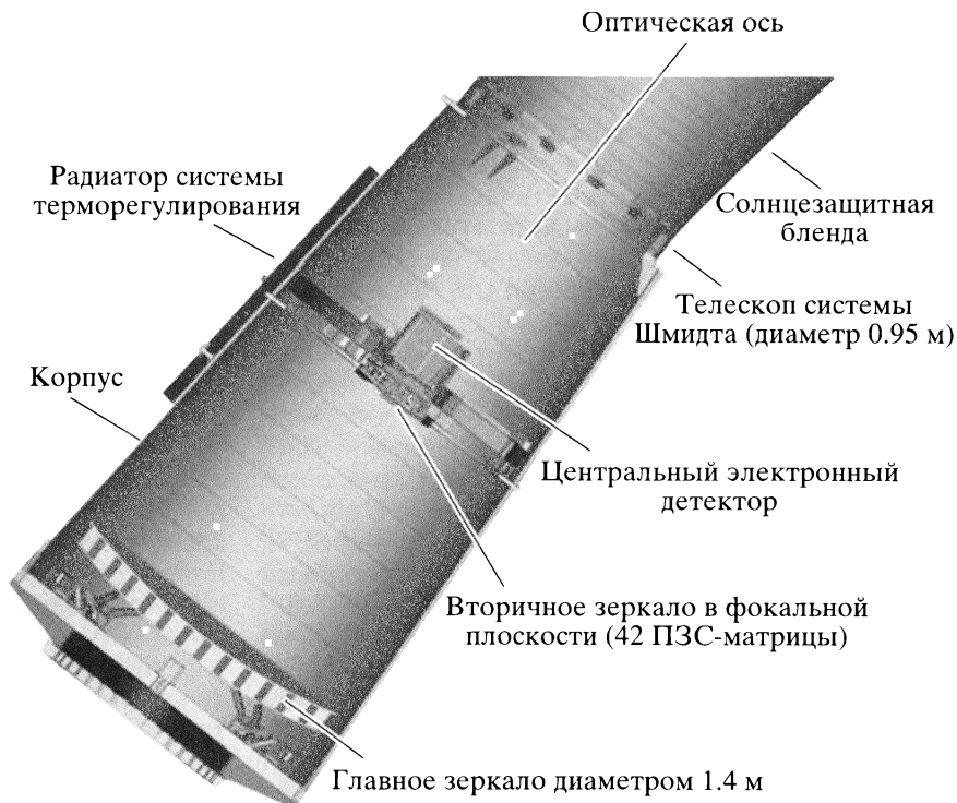
Общее устройство космической обсерватории “Кеплер” (США). Рисунок NASA.
