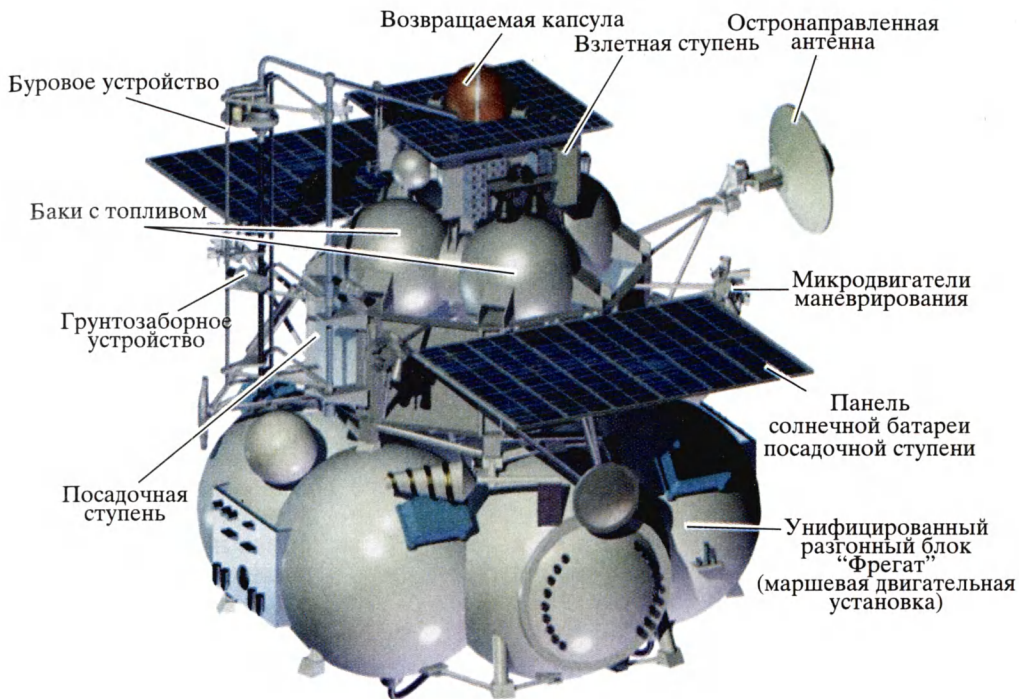
Размещение научной аппаратуры и систем на российской АМС "Фобос-грунт". Рисунок НПО им. С.А. Лавочкина.
