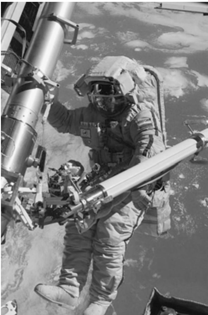
Космонавт А.Н. Шкаплеров переносит грузовой кран “Стрела-2” для его монтажа на модуль “Поиск”. 16 февраля 2012 г. Фото NASA.
