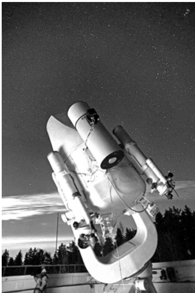
Камера ВАУ с телескопом "Сантел-500" и высокочувствительной ПЗС-камерой Звенигородской обсерватории. 12 декабря 2010 г. Фото В.А. Ромейко.
