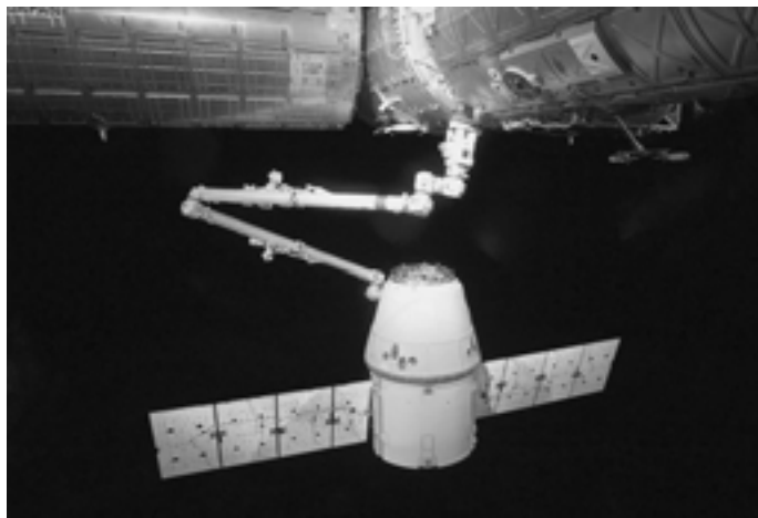
Частный грузовой КК “Дрэгон” (США) с помощью манипулятора “Канадарм-2” стыкуется к модулю “Гармония” американского сегмента МКС. 25 мая 2012 г. Фото NASA.
