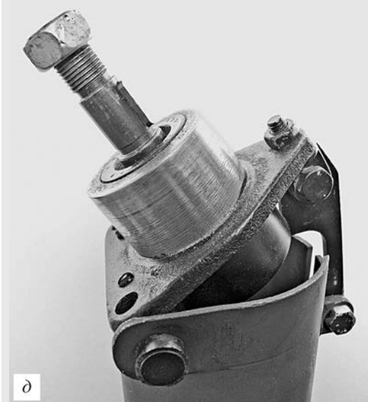
Основные части монтировки: а) общий вид сбоку; б) вид снизу; в, г) крепление электромотора к механизму перемещения телескопа; д) полярная ось и узел изменения ее наклона; е) узел для корректировки положения полярной оси в основании колонны.
