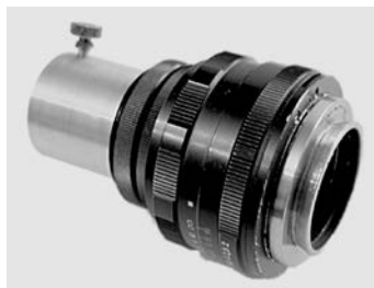
Фокусер, изготовленный из объектива фотоаппарата "Гелиос-44".
