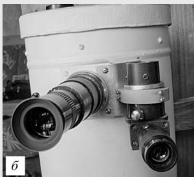
Окулярный узел телескопа и искатель: а) телескоп, подготовленный к транспортировке, б) рабочий вариант, в) вместо перекрестия нитей в искателе установлена V-образная метка.
