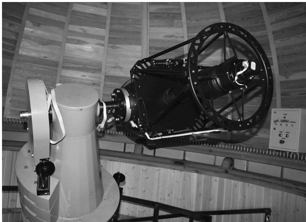
360-мм телескоп системы Ричи – Кретьена, подаренный Планетарию А.Н. Савельевым (фирма “Астросиб”, Новосибирск). Фото В. Анисько.
