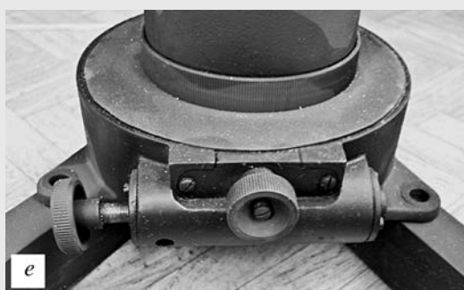
Основные части монтировки: а) общий вид сбоку; б) вид снизу; в, г) крепление электромотора к механизму перемещения телескопа; д) полярная ось и узел изменения ее наклона; е) узел для корректировки положения полярной оси в основании колонны.
