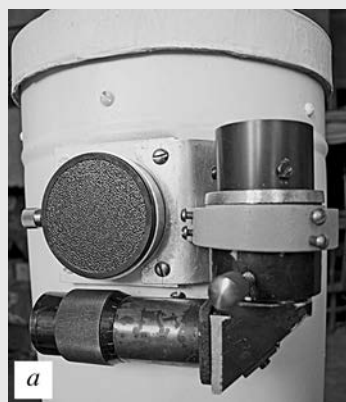
Окулярный узел телескопа и искатель: а) телескоп, подготовленный к транспортировке, б) рабочий вариант, в) вместо перекрестия нитей в искателе установлена V-образная метка.
