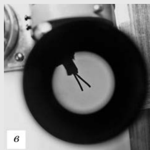
Окулярный узел телескопа и искатель: а) телескоп, подготовленный к транспортировке, б) рабочий вариант, в) вместо перекрестия нитей в искателе установлена V-образная метка.
