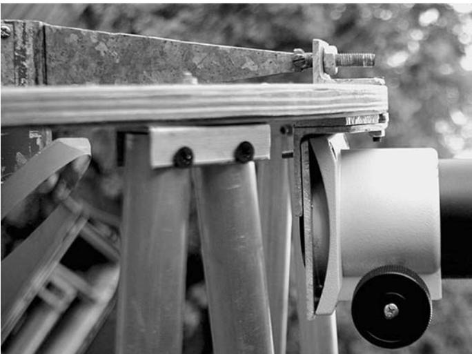
*Верхняя часть фермы телескопа с окулярным узлом.*
