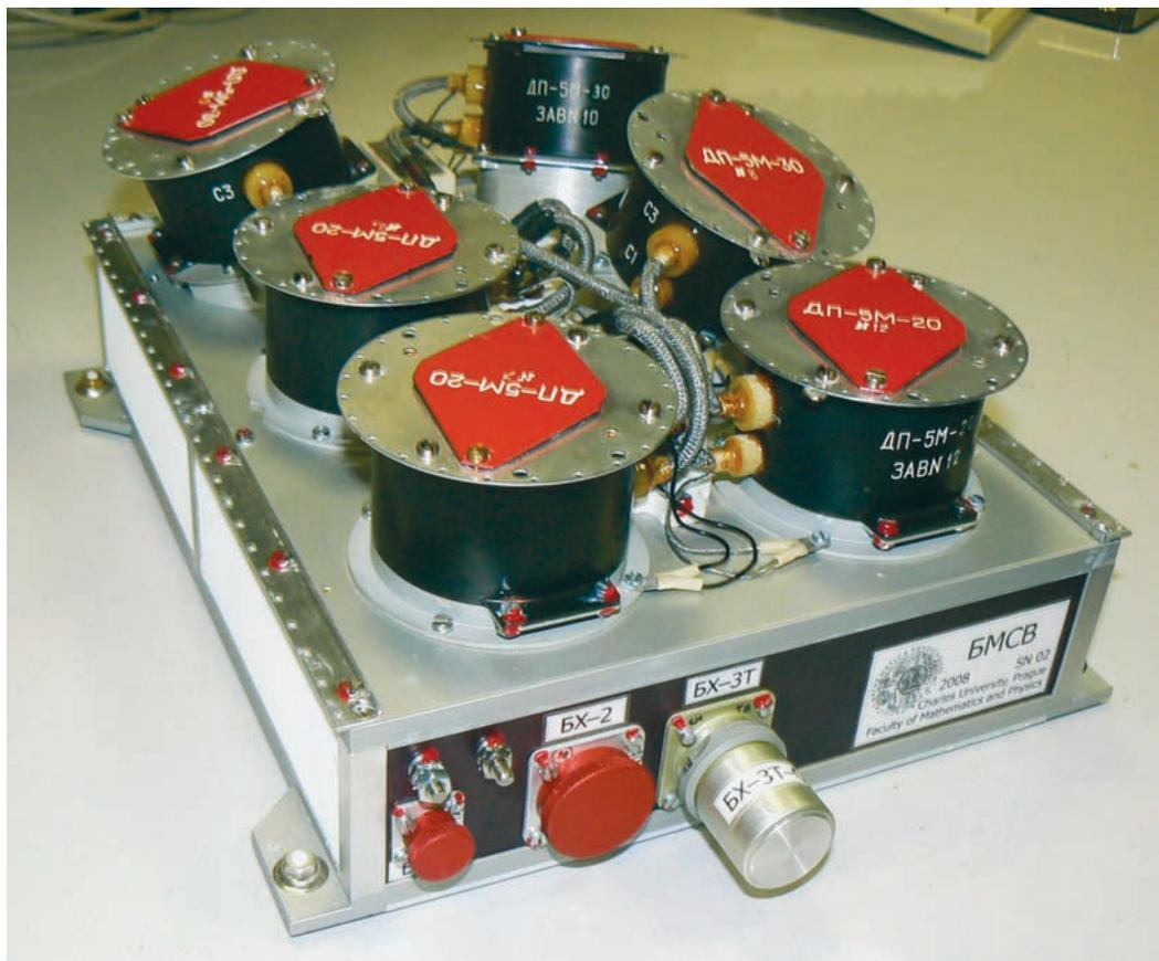
второй группы (“отвернутые”) предназначены для быстрого измерения интенсивности потока ионов солнечного ветра и определения направления его вектора. Оси датчиков этой группы были отклонены от главной оси прибора на  $20^\circ$  и друг от друга на  $120^\circ$ .
