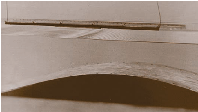
Волна, созданная волнопродуктором, распространяется слева направо навстречу потоку. Неоднородность течения вдоль лотка создается специальным профилем дна. Наблюдается блокировка гравитационной волны. Лабораторный эксперимент.
