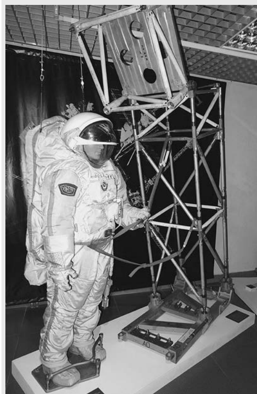
Скафандр "Орлан-Т" (внизу – устройство крепления ног "Якорь") и ферма "Софора". Ферма собиралась на модуле "Квант" станции "Мир".
