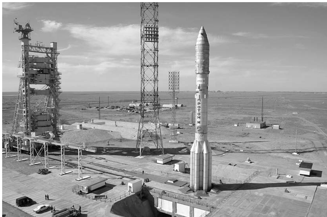
Четырехступенчатая РН "Протон-М" с разгонным блоком "Бриз-М" на стартовой площадке № 81. 2014 г.
