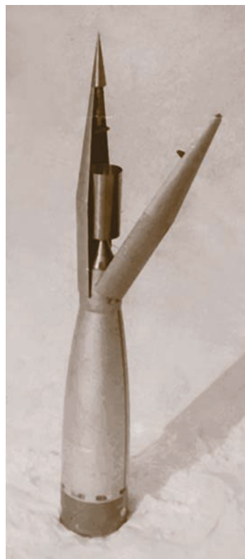
Приборная часть метеорологической ракеты с конденсатором Жердьена.
