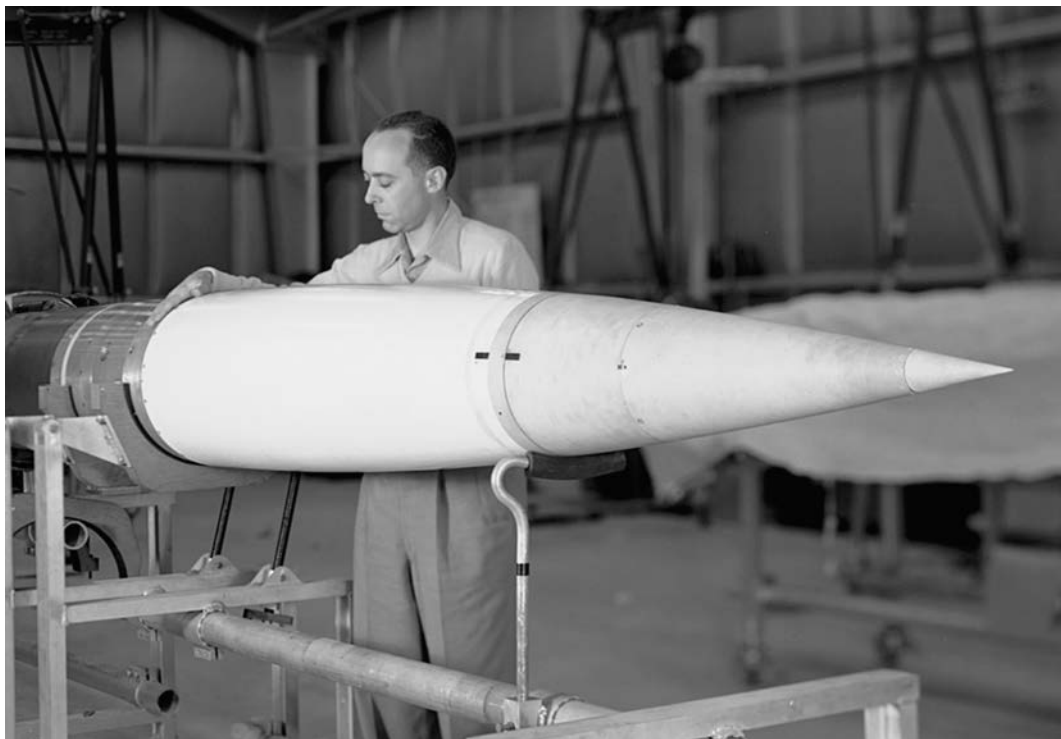
Сборка американской неуправляемой суборбитальной зондирующей ракеты “Аэроби-150” (“Aerobee”). В 1950-х гг. она применялась для высотного исследования атмосферного и космического излучения.
