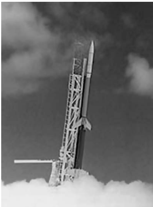
Запуск ракеты “Nike-Asp” с атолла Джонсона в Тихом океане 22 сентября 1967 г. В головной части находился датчик, разработанный в Радиационной лаборатории Министерства энергетики США для изучения рентгеновского источника Скорпион X-1.
