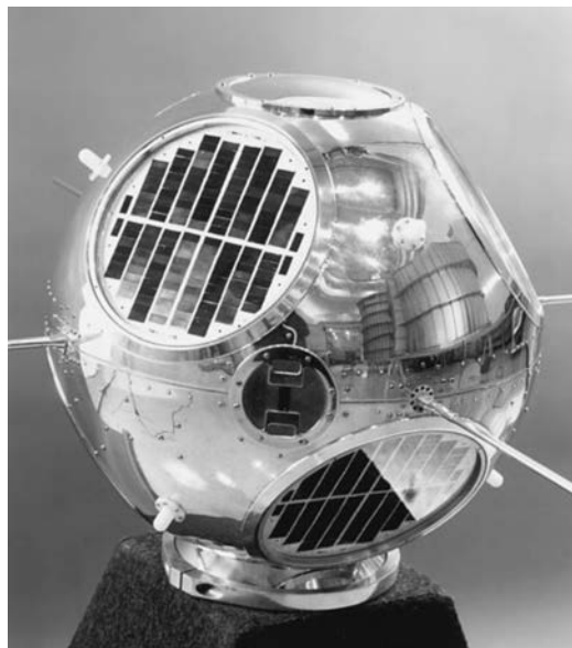
ИСЗ “Солрад” (“Solrad-1”) для исследования солнечного рентгеновского излучения, запущен 22 июня 1960 г. В 1960–1976 гг. запущено 16 спутников этой серии, из них 12 – успешно. Фото NASA.
