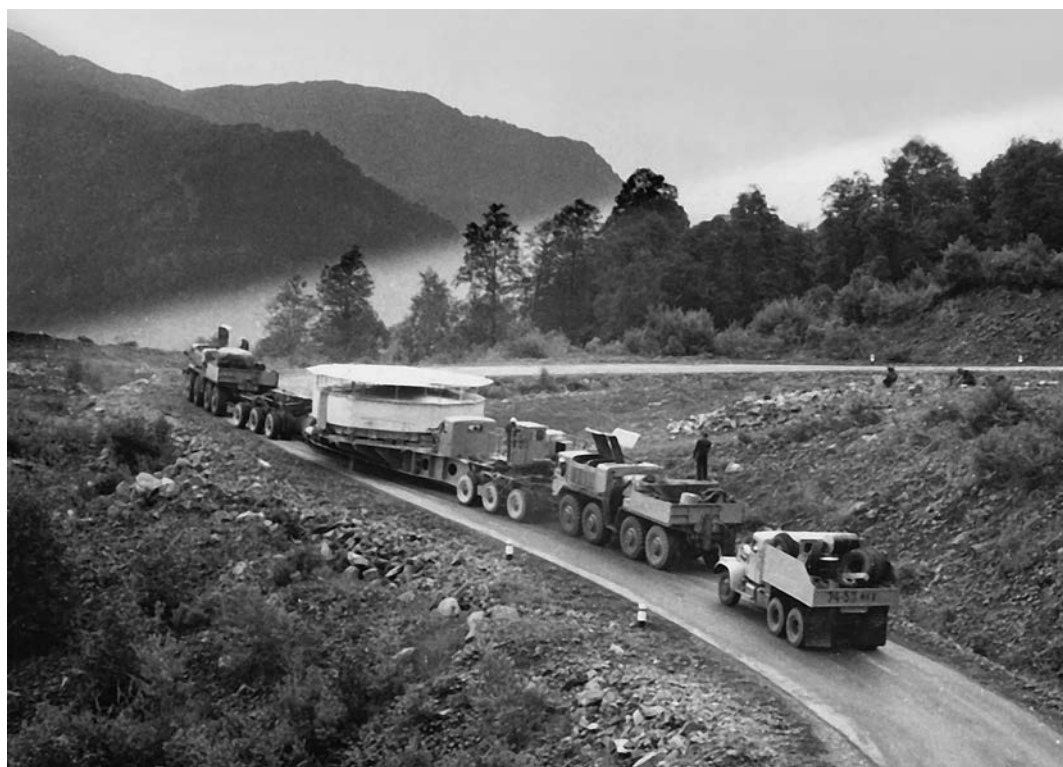
Транспортировка 6-м главного зеркала БТА по горной дороге на пути к башне Обсерватории. Август 1974 г.
