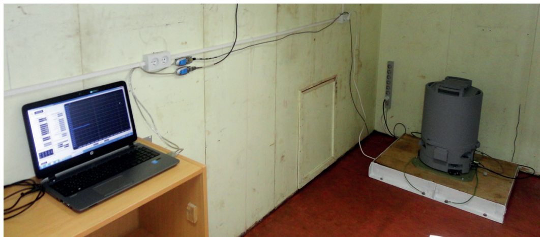
Общий вид современного морского гравиметра “Шельф” (справа), установленного на борту научно-исследовательского судна “Согар”.
