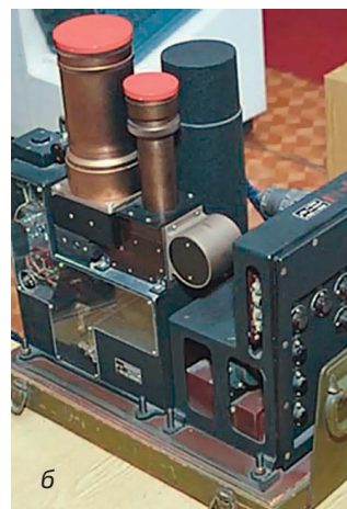
Устройство АМС "Луна-3" (а) и ее бортовая фототелевизионная аппаратура "Енисей" (б)
