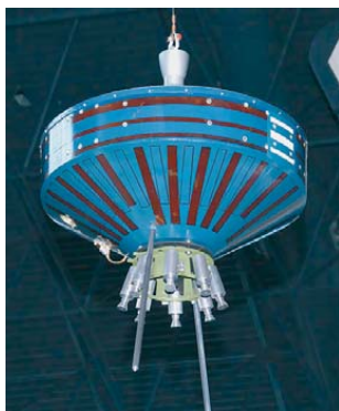
Аппараты первого типа "Пионер-0" – "Пионер-2" (США) для полетов к Луне. Фото NASA
