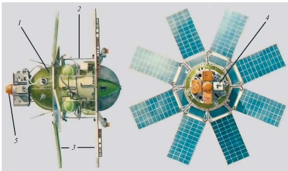
Схема ИСЗ серии "Космос" типа ДС-УЗ для исследования коротковолнового излучения Солнца: 1 – отсек под электронный блок научной аппаратуры, 2 – экранно-вакуумная термоизоляция, 3 – панели солнечных батарей, 4 – датчики научной аппаратуры, 5 – солнечный датчик системы ориентации
