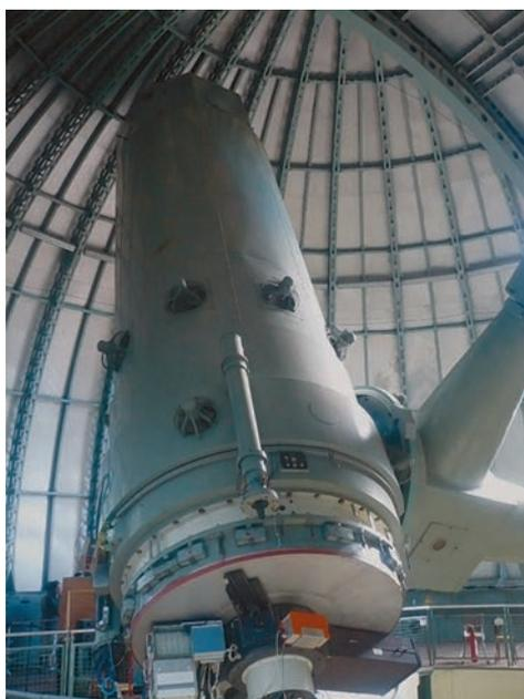
1.93-м рефлектор обсерватории От-Прованс (Haute-Provence), Франция, установленный в 1958 г., со спектрографом ELODIE. На этом инструменте открыто 20 экзопланет (включая 51 Peg).
