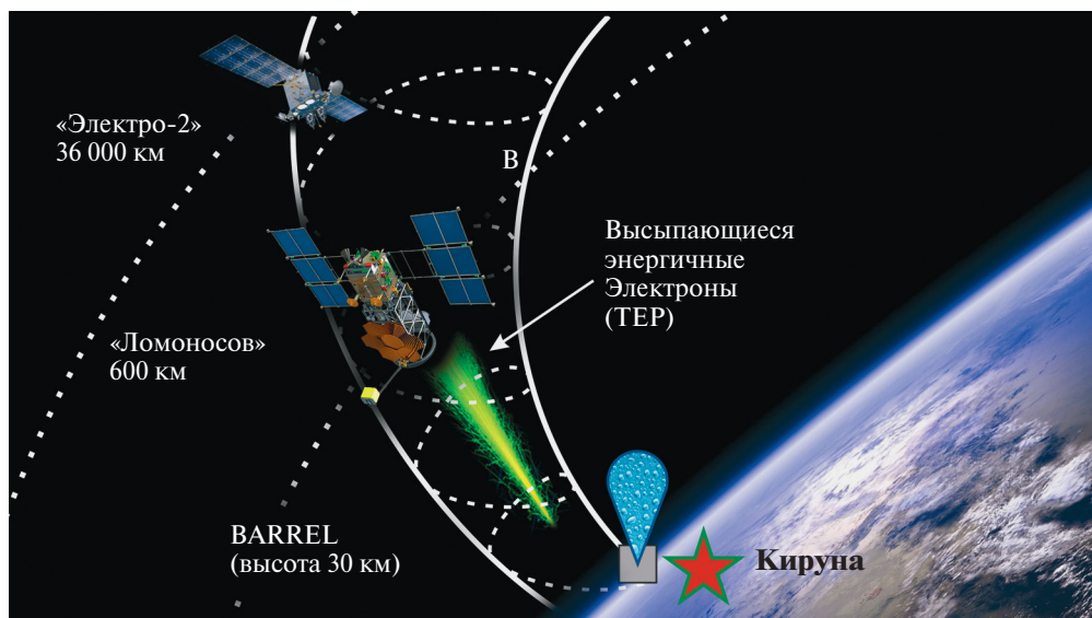
Рис. 10. Эксперимент по синхронным измерениям процесса высыпания энергичных электронов из радиационных поясов: спутник «Электро-2» на геостационарной орбите (36 000 км) регистрировал изменения параметров плазмы, спутник «Ломоносов» на низкой орбите (600 км) – потоки электронов, а на аэростате, запущенном из Кируны, Швеция – тормозное излучение высыпавшихся электронов (эксперимент BARREL)
