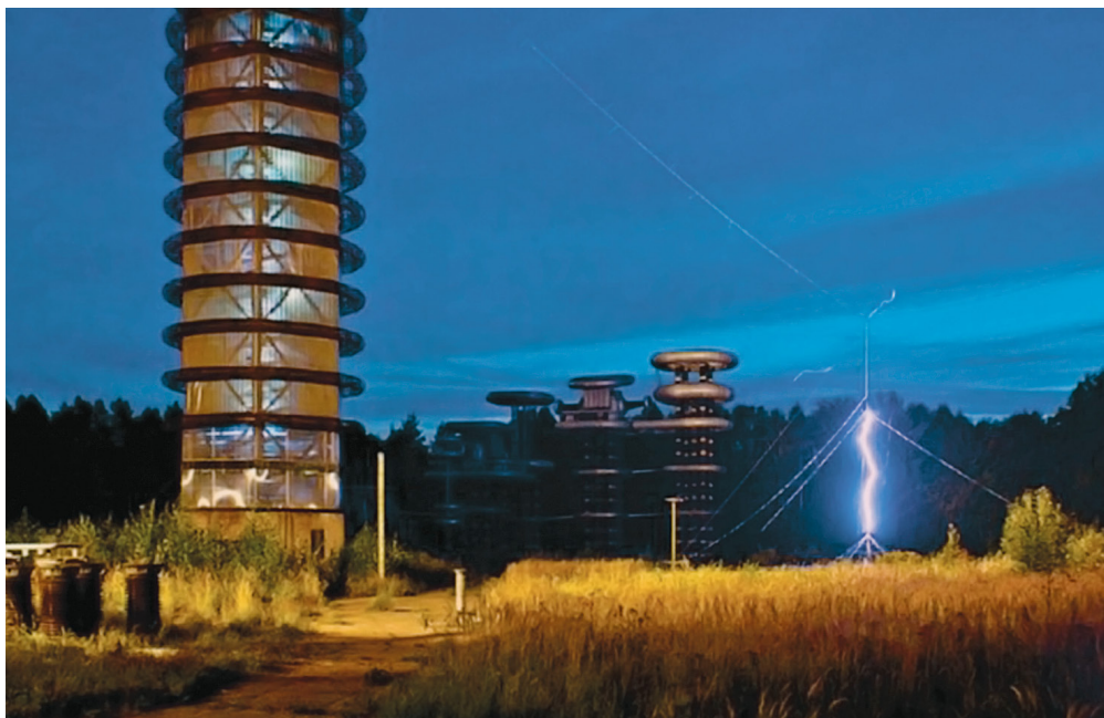
Рис. 4. Экспериментальные установки высоковольтного испытательного стенда (г. Истра). Слева виден генератор Маркса, способный создавать разность потенциалов амплитудой 6 МВ. Справа расположен разрядный промежуток, перекрытый 9-метровым каналом положительной длинной искры. Рисунок Kostinskiy A.Yu. Abrupt elongation (stepping) of negative and positive leaders culminating in an intense corona streamer burst: Observations in long sparks and implications for lightning / A.Yu. Kostinskiy, V.S. Syssoev, N.A. Bogatov et al. // Journal of Geophysical Research: Atmospheres. 2018. V. 123, No. 10. P. 5360–5375
