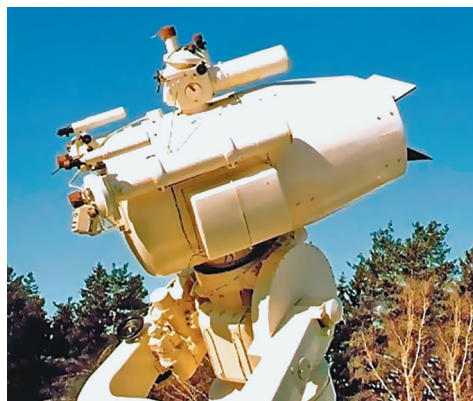
Высокоточная астрономическая установка ИНАСАН. Спустя 50 лет телескоп продолжает определять точные координаты спутников
