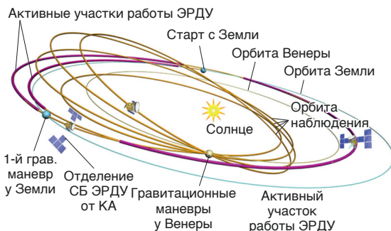
Рис. 19. Слева – два космических аппарата в проекте Интергелиозонд приблизятся к Солнцу на расстояние в 60 солнечных радиусов. Справа – один из вариантов орбиты сближения космического аппарата Интергелиозонд с Солнцем с использованием электрореактивной двигательной установки (ЭРДУ) и многократных гравитационных маневров у Венеры с одновременным наклоном орбиты к плоскости эклиптики до 27°
