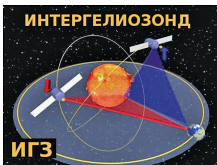
Рис. 19. Слева – два космических аппарата в проекте Интергелиозонд приблизятся к Солнцу на расстояние в 60 солнечных радиусов. Справа – один из вариантов орбиты сближения космического аппарата Интергелиозонд с Солнцем с использованием электрореактивной двигательной установки (ЭРДУ) и многократных гравитационных маневров у Венеры с одновременным наклоном орбиты к плоскости эклиптики до 27°
