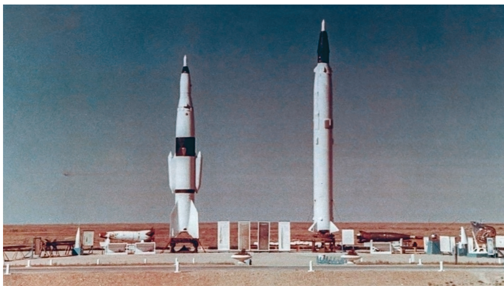
Геофизические ракеты Р-2А и Р-5А для проведения атмосферных, ионосферных и радиофизических исследований. Космодром Капустин Яр
