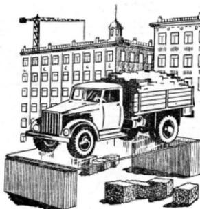
Лист сталинита, положенный на две опоры, не разрушается от веса грузового автомобиля
