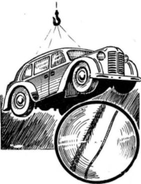
Диаметр стеклянной нити в три раза меньше диаметра хлопковой. Тонкий шнур из стеклянных нитей выдерживает тяжесть автомобиля.
