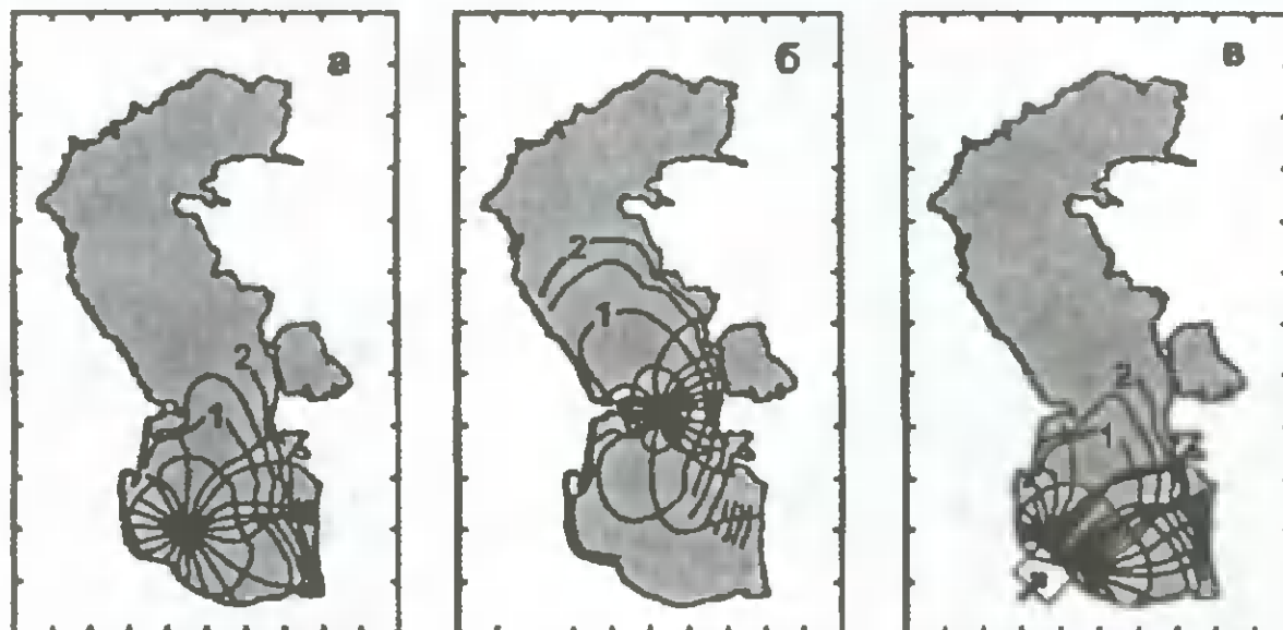
Карты распространения цунами из сейсмических источников, расположенных в центре Южнокаспийской глубоководной впадины (а), в средней части Апшеронского порога (б) и у южного побережья моря (в)
