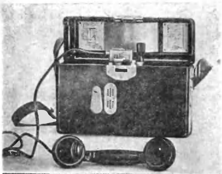
Рис. 19. Полевой телефонный аппарат «Фельд-ферншпрехер-33». Дальность действия до 100 км; вызов индукторный; вес 5750 г.
