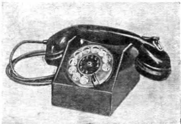
Рис. 20. Полевой телефонный аппарат настольного типа с номеронабирателем (применяется в крупных штабах). Дальность действия до 100 км; вес — 1,5 кг.
