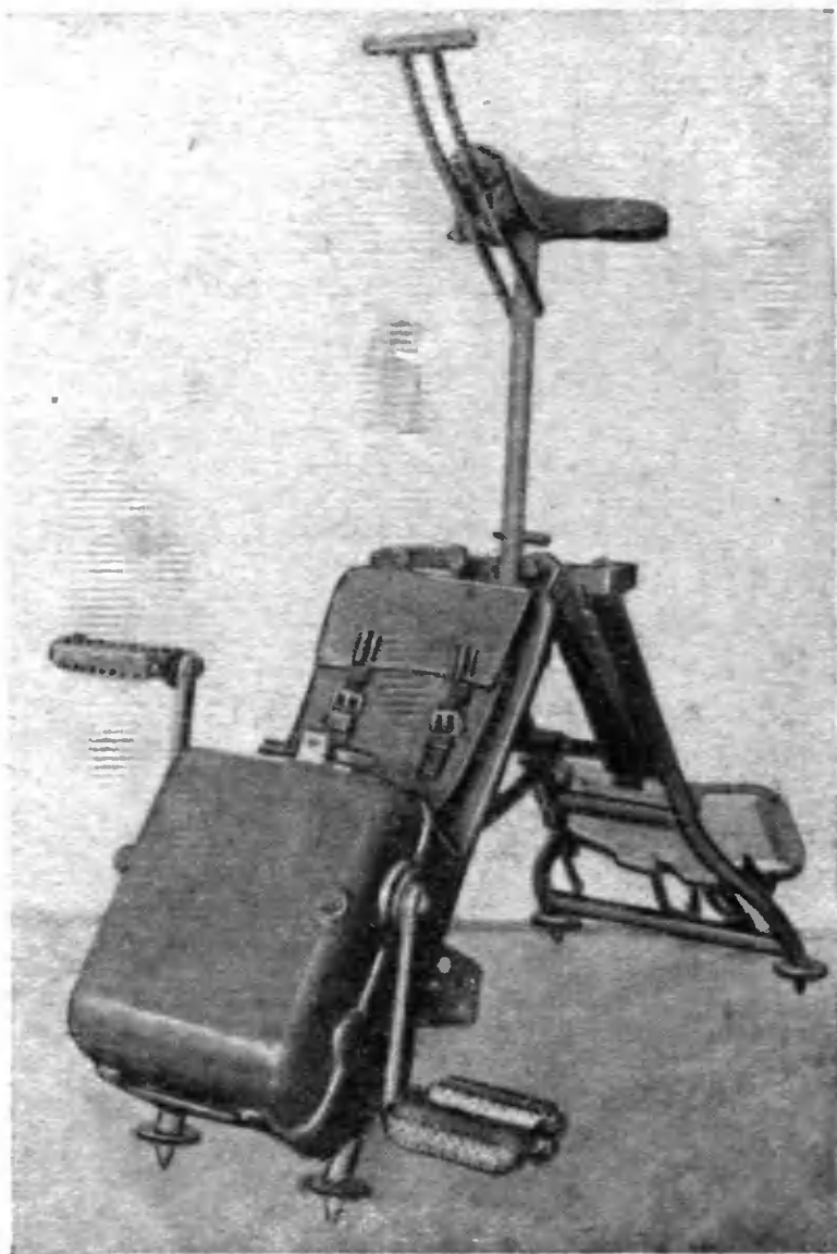
Рис. 26. Генератор с ножным приводом типа ТМ 150.
