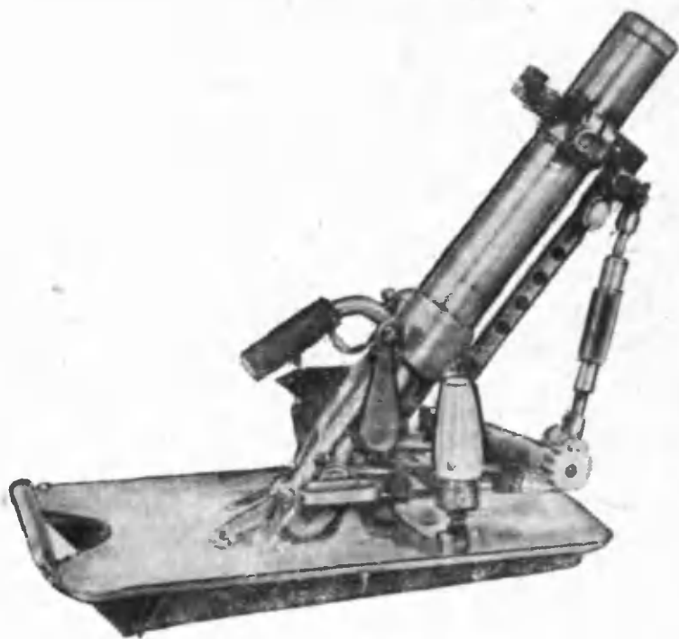
Рис. 8. 55-мм гранатомет.
