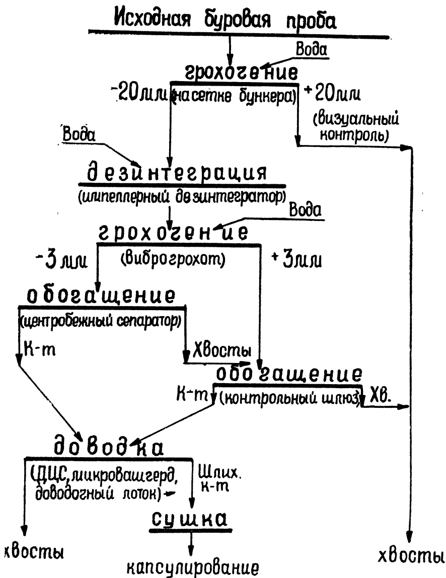
Р и с. 2. Технологическая схема обработки шламовых проб на установке «Проба-2М»
