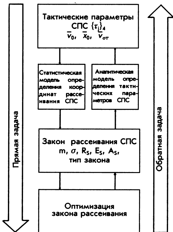
Рис. 2.5. Схема постановки задачи для определения характеристик рассеивания СПС ( \bar{v}_0, \bar{x}_0, \bar{v}_{от} – начальные векторы положения, скорости, отстрела СПС; m – математическое ожидание; \sigma – СКО; E_s, A_s – эксцесс и асимметрия)
