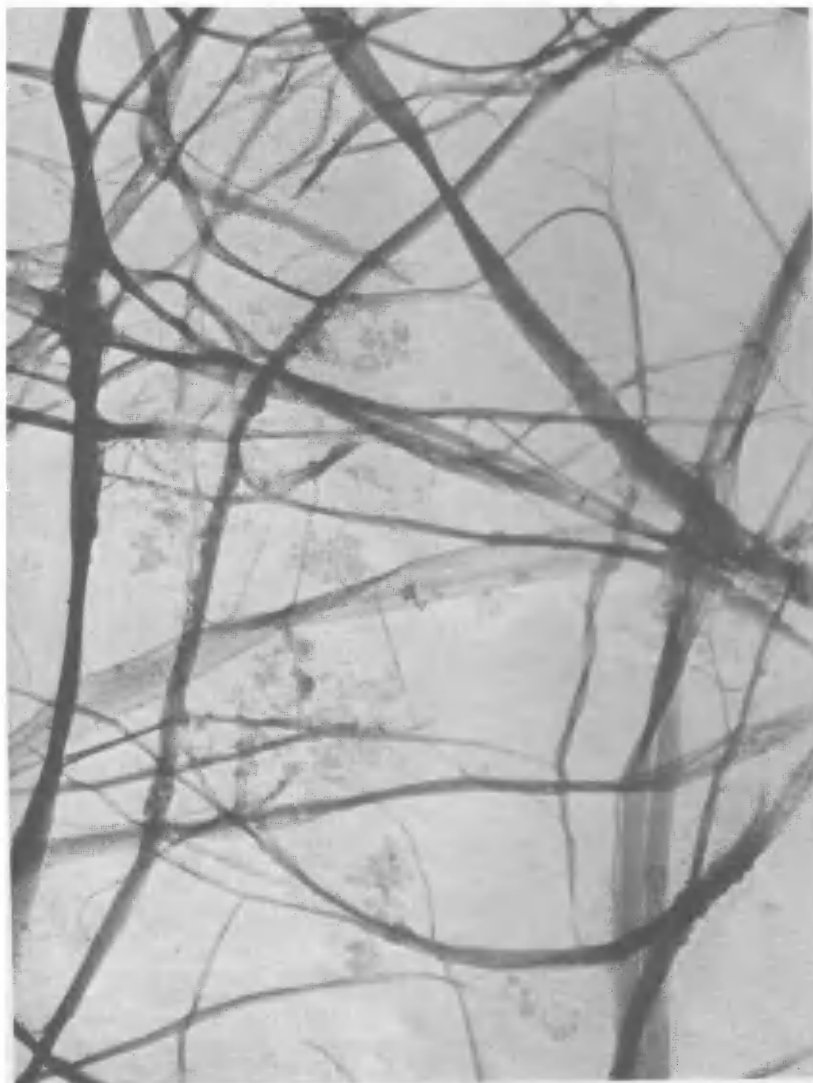
Так выглядят шелковые волокна под электронным микроскопом. Увеличение примерно в 6000 раз
