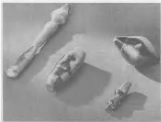
Типичные образцы кристаллов для изучения полупроводниковых свойств и физики твердого тела. На снимке — кристаллы теллурида висмута, а также индий-сурьмяного сплава
