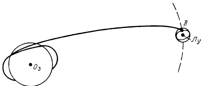
Рис. 4.8. Схема перелета к Луне: J_y — упрежденная точка; В — точка входа космического аппарата в сферу действия Луны
