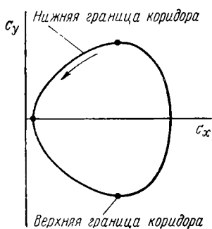
Рис. 6.26. Изменение угла атаки при полете аппарата вдоль нижней и верхней границ коридора
