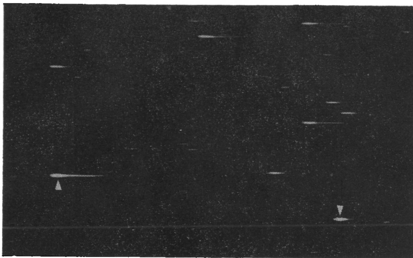
Рис. 10.1. Фрагмент одного кадра, полученного с помощью «Ориона-2». Видны ультрафиолетовые спектрограммы двух звезд почти одного и того же блеска, одна из которых класса A0 (SAO 040280, стрелка слева), другая — класса K0 (SAO 040242, стрелка справа). На этом примере видно, как резко могут отличаться формы и в особенности длины спектрограмм в ультрафиолетовой области в зависимости от спектрального класса (эффективной температуры) звезды
