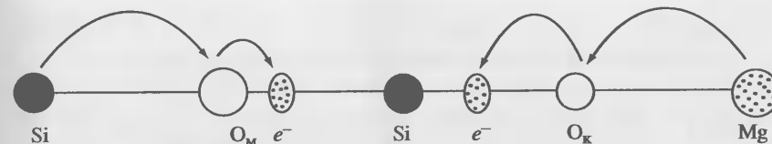
Рис. 1.3. Локализация электронной плотности в системе связей \text{Si}-\text{O}_m-\text{Si}-\text{O}_k-\text{Mg} в протоэнстатите [Лубау, 1988]
