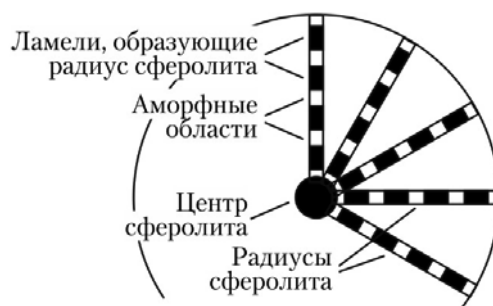
Рис. 5. Микрофотография сферолита полипропилена (а) и схематическое изображение структуры сферолита (б)
