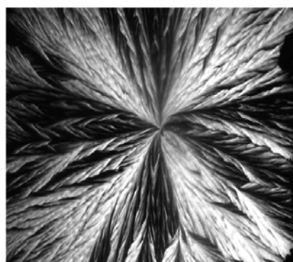
Рис. 5. Микрофотография сферолита полипропилена (а) и схематическое изображение структуры сферолита (б)
