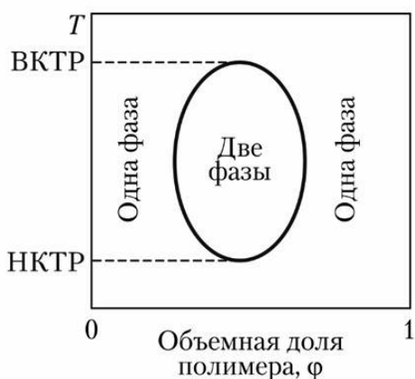
Рис. 3. Фазовые диаграммы двухкомпонентных систем «полимер-растворитель»: НКТР < ВКТР (слева) и НКТР > ВКТР (справа)
