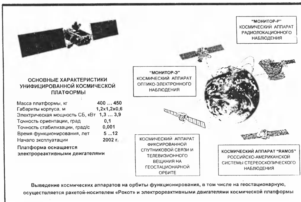
Рис. 8. Унифицированная космическая платформа и модификации космических аппаратов на ее основе
