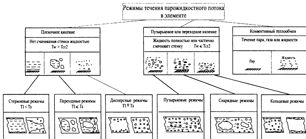
Рис. 1. Режимы течения парожидкостного потока в элементе магистрали при захлаживании
