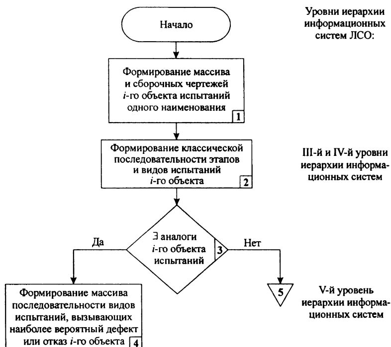
Рис. 3. Алгоритм формирования массива аналогичных объектов испытаний
