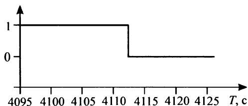
Рис. 7. Регистрация сигнального параметра «команда «Внимание-1» для перевода заправки окислителем баков РН на «малый расход»: время — 4112,400 с
