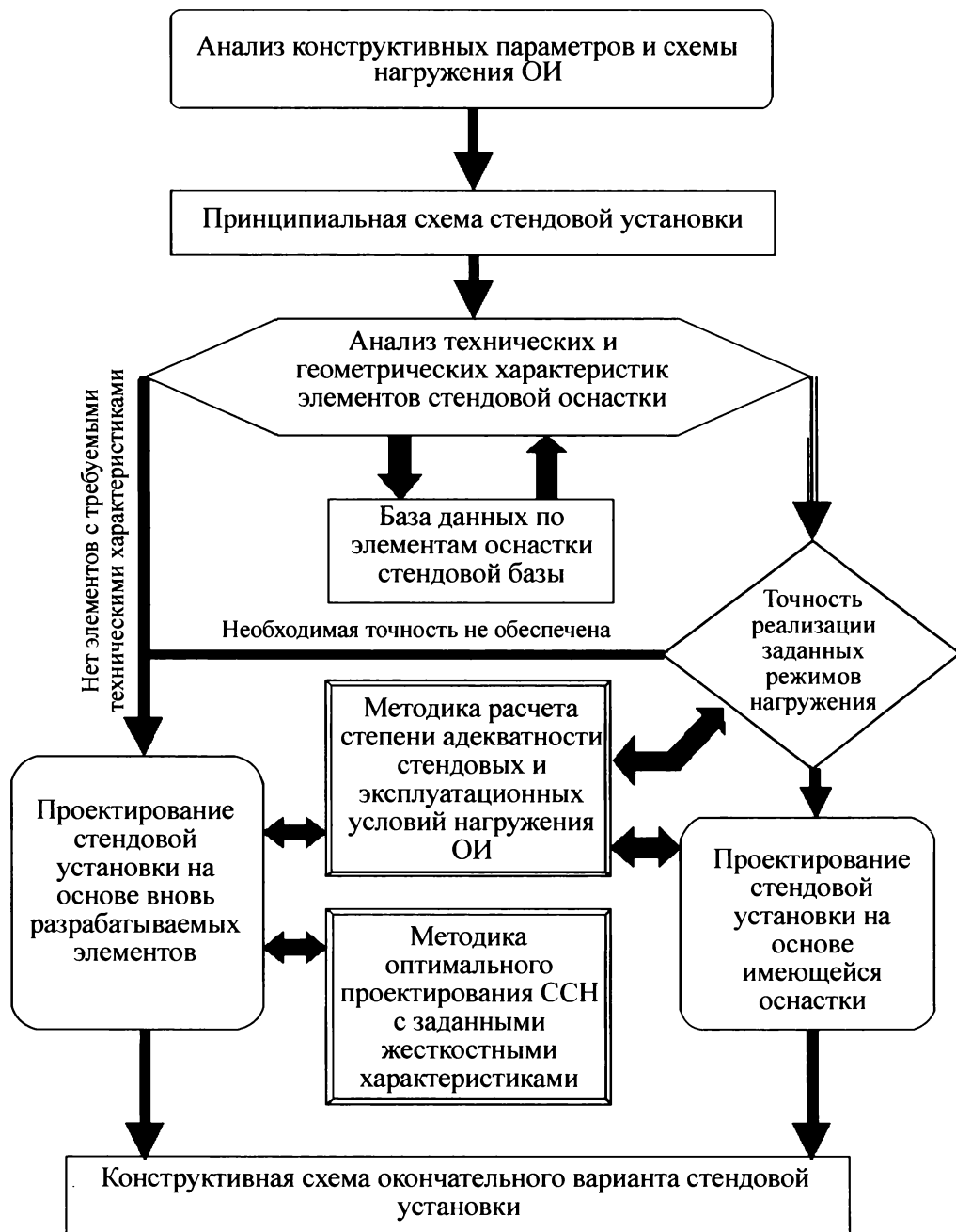
Рис. 3. Схема комплексной методики проектирования ССН для статических испытаний
