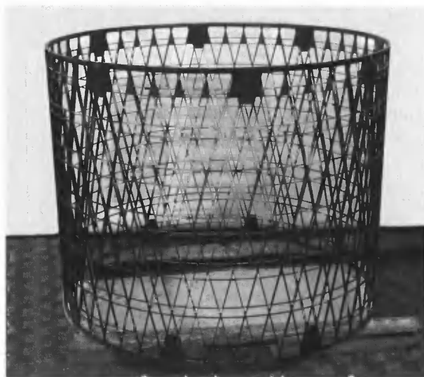
Рис. 2. Силовой цилиндр нерегулярной структуры (КА «Экспресс-МД1»)
