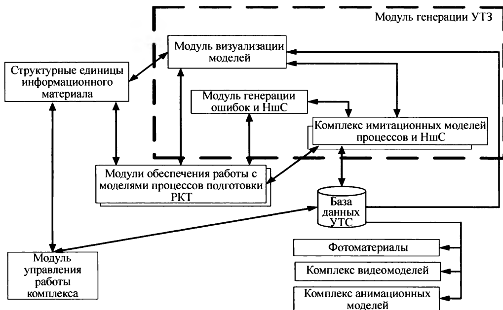
Рис. 2. Взаимодействие модулей имитационной модели
