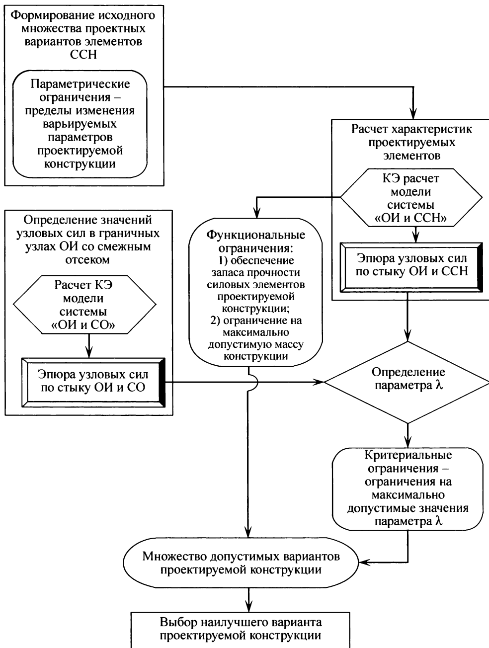
Рис. 2. Схема проектирования элементов ССН с заданными жесткостными характеристиками
