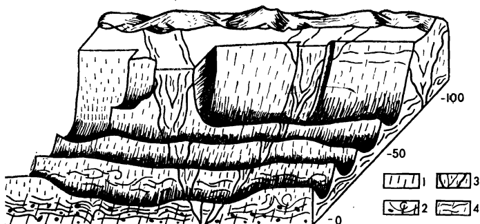
Рис. 11. Блок-диаграмма карьера, в стенке которого вскрывается система древних полигональных жил. Основания жил достигают глубины 5 м
