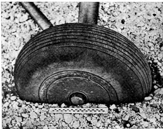
Рис. 7.2. Глубокое погружение колеса вертолета МИ-4 на рыхлых отложениях вулкана Шивелуч на Камчатке
