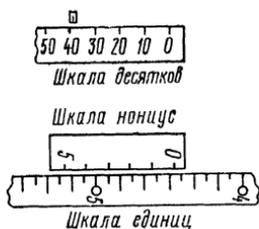
Рис. 6.5. Отсчет высоты при измерении без осредняющего механизма
