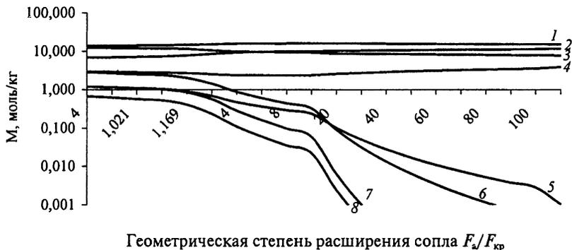
**Рис. 4.** Изменение молярных концентраций компонентов смеси газов рабочего тела по длине проточной части сопла:
