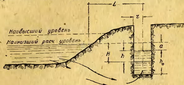
Рис. 13. Схема инфильтрационного колодца
