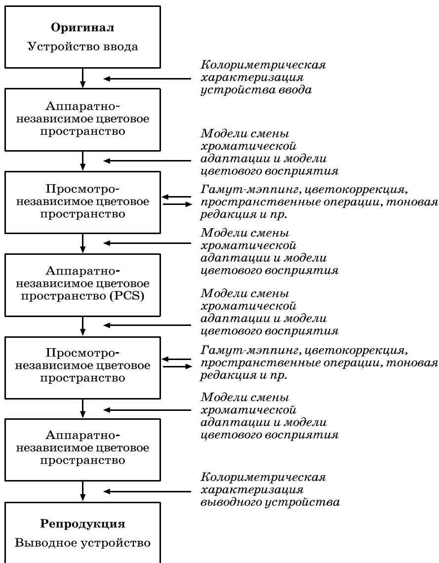
Рис. 19.4 Общая схема процесса аппаратно-независимого цветовоспроизведения, обновленная концепцией пространства связи профайлов (ICC).
