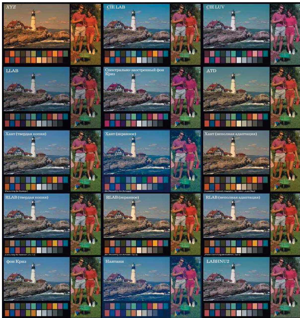
Рис. 17.4 Сравнение прогнозов, выполненных различными моделями цветового восприятия для ситуации перехода от хроматической адаптации по А-осветителю к адаптации по D65-осветителю. Оригинальное изображение представлено прямым репродуцированием XYZ-значений пикселей (без расчета смены адаптации).
