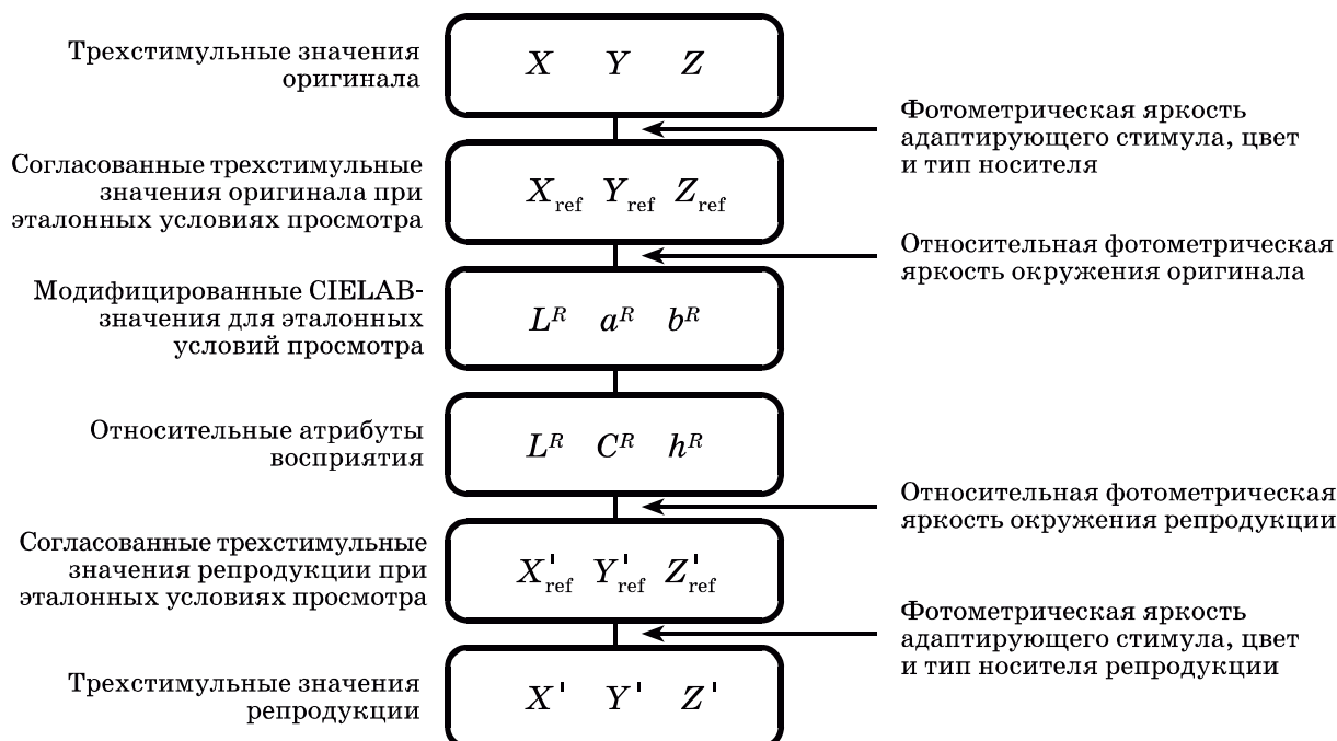
Рис. 13.4 Поточная диаграмма применения RLAB-модели к процессу репродуцирования изображений.
