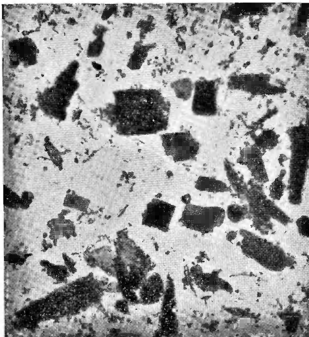
Р и с. 4. Кристаллы «красной фазы» (снято в иммерсии, проходящий свет, без анализатора, увелич. 300)
