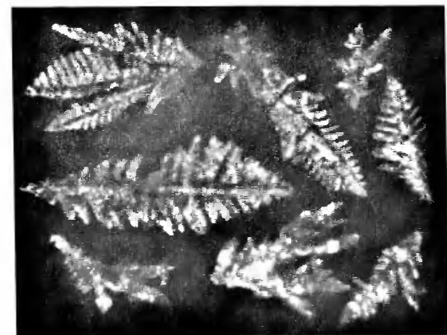
Рис. 99 Типичные дендриты электролитического ниобия, полученные рафинированием металлокерамического ниобия при 800° С в электролите K_2NbF_7-(KCl+NaCl)_{\text{эвк}} с 15% K_2NbF_7 , \times 3
