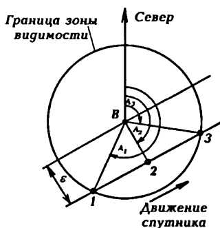
Рис. 28.5. Азимуты для характерных точек орбиты
