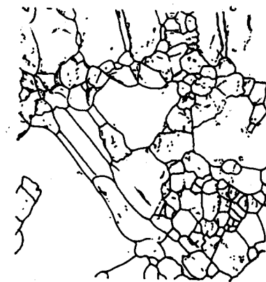
Рис. 7. Вид протравленного шлифа поликристалла
