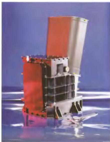
Рис. 3-5. Общий вид системы изображений тепловой эмиссии THEMIS
