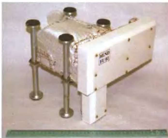
Рис. 3-6. Общий вид прибора HEND с технологическими подставками
