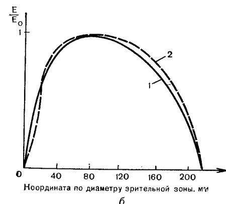
Рис. 112. Измеренные относительные значения интенсивности света E/E_0 в зрительной зоне: а — при наличии объектива; б — без объектива; 1 — в горизонтальном направлении; 2 — в вертикальном направлении
