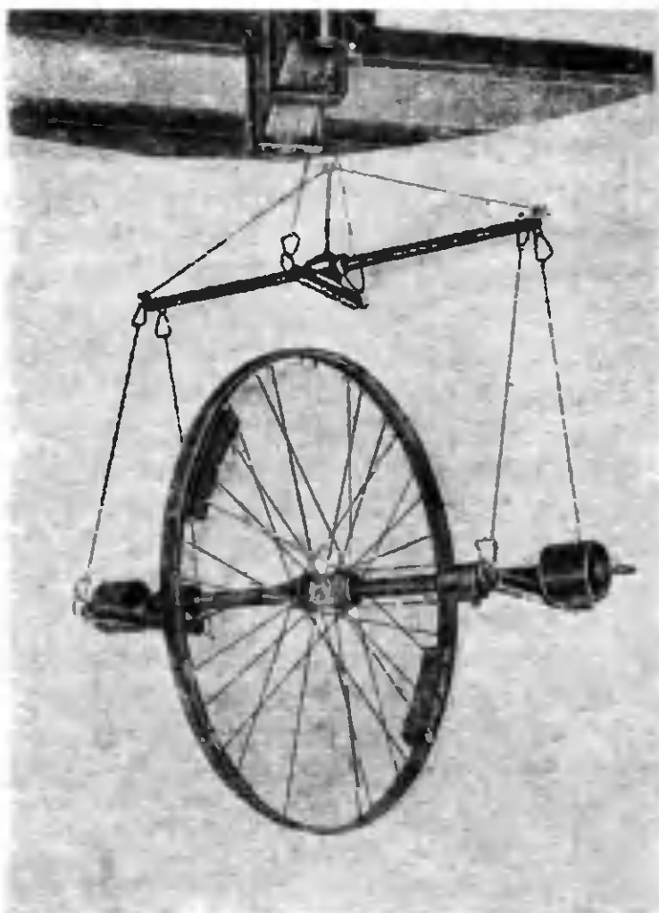
Рис. 153. Модель для демонстрации устойчивости вращения вокруг главных осей инерции. (Кабинет механики Ленинградского Физико-механического института).
