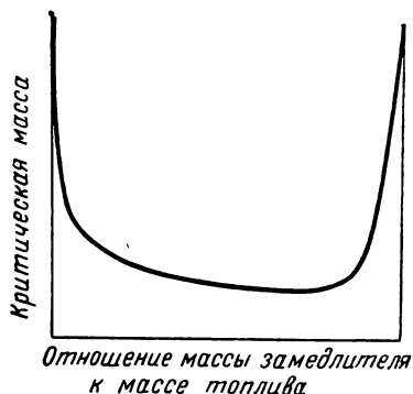
Рис. 11.7. Изменение критической массы сферического реактора в зависимости от относительного количества замедлителя
