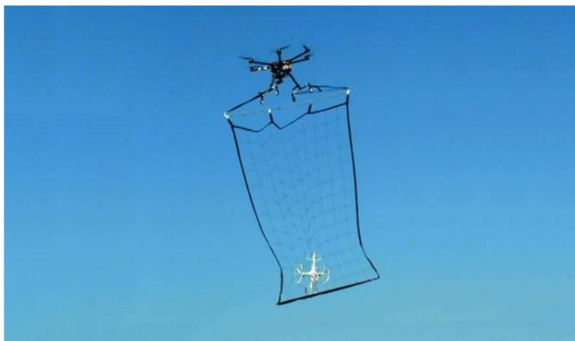
Рис. 7.2. Использование БПЛА-перехватчиков оборудованных сетью [279]
