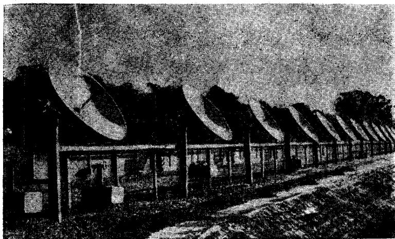
Рис. 130. Радиointерферометр с 32 параболическими антеннами
