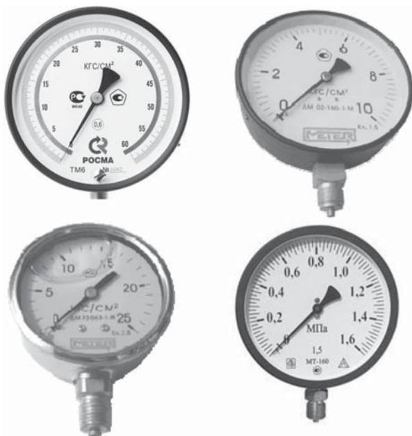
Рис. 2.10. Классы точности манометров
