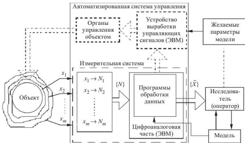
Рис. 2.4. Схема исследования сложного объекта с помощью измерительной системы
