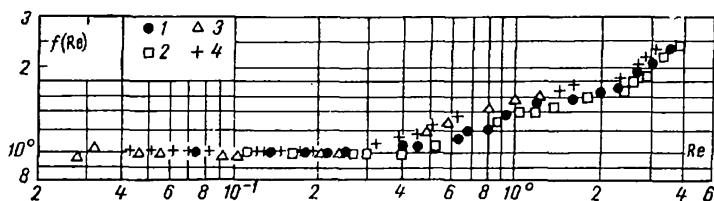
Рис. 3. Представление экспериментальных данных Н. М. Жаворонкова, М. Э. Аэрова и Н. Н. Умника в виде f = f(Re) :
